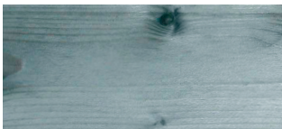
Unbehandelte Oberfläche Folge: Holz vergraut vollflächig
