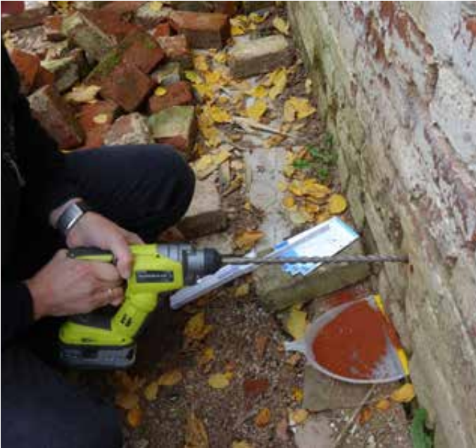
Фото 1. Взятие проб для анализа содержания в стене ОКН солей и оценки показателей влажности.
