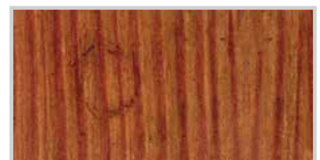
Uderzenie gradu po upływie 1 roku Z balsamem: powłoka zachowała funkcję
