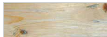
Zwykła lazura bezbarwna bez ochrony przed UV. Skutek: nieodwracalne zszarzenie i/lub oznaki sinizny
