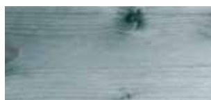
Surowa powierzchnia Skutek: drewno zszarzałe na całej powierzchni
