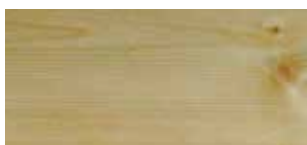
Dauerschutz-Lasur UV, bezbarwny UV+ Skutek: nienaruszona powierzchnia dzięki blokerom UV
