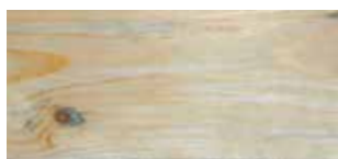
Zwykła bezbarwna lazura, bez ochrony przed UV Skutek: nieodwracalne zszarzenie/sinizna
