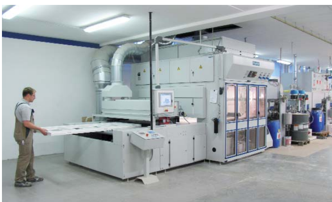
Fertigungsstraße mit Reinigungsstation, Durchlauf-Flächenspritzmaschine, Trockensystem OIR (Optimiertes Infrarot) und Düsentrockner mit anschließender UV-Härtung.
