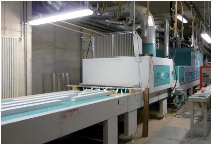
Mit der UV-Vernetzung wird der Lackiervorgang abgeschlossen.
