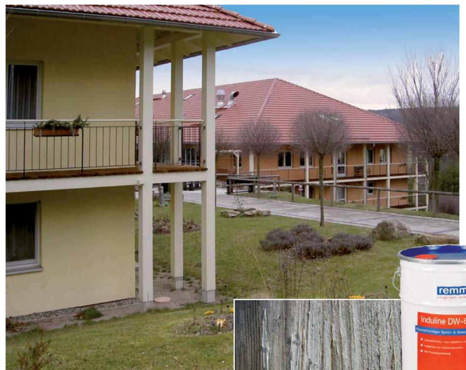
Das Ergebnis war sehr zufriedenstellend. Trotz extremer Bewitterung waren die Oberflächen der mit Induline DW-610 beschichteten Holzkonstruktion 5 Jahre nach den Renovierungsarbeiten in einem sehr guten Zustand. Selbst die waagerechten Flächen wiesen keine Schäden auf.
