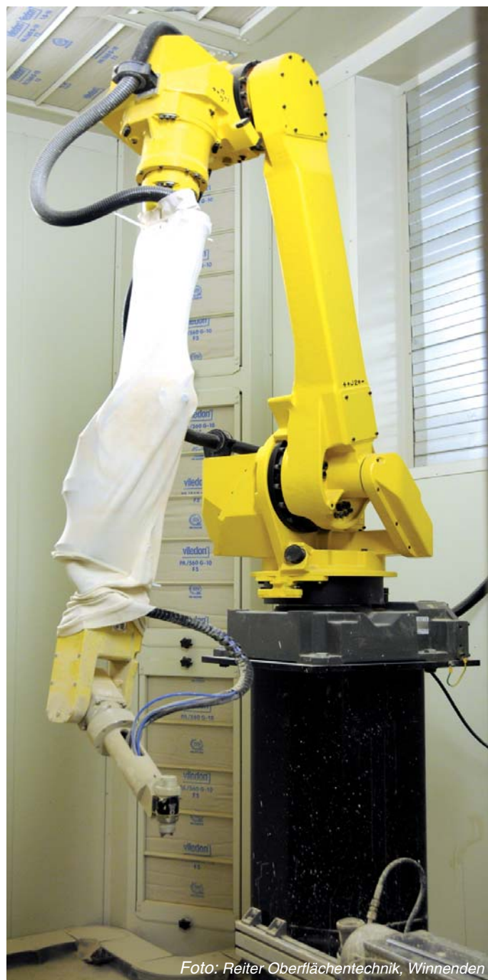
Vollautomatischer 6-Achs Lackierroboter mit 3D Teile-Erkennung
