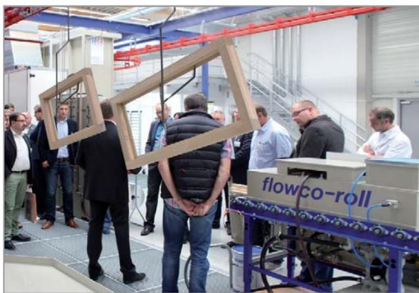
Die moderne Anlagentechnologie bietet die Möglichkeit, durch Realsimulation Anwendungen praxisnah nachzustellen. Hier zu sehen: Flutanlage „Flowco-roll“ von Range & Heine für die Einzelteil-Imprägnierung.
