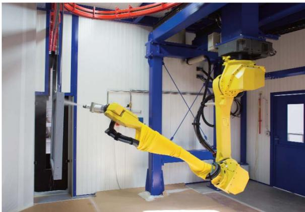
Der vollautomatische Sechssachs-Lackierroboter mit 3D-Teilerkennung aus dem Hause Reiter im Einsatz.
