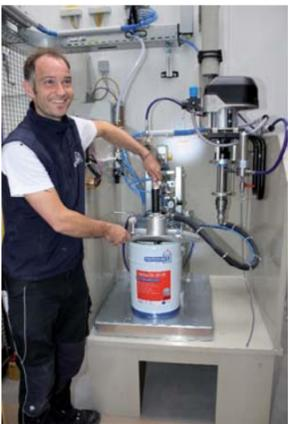
Demonstration der Farbversorgung des Roboters.
