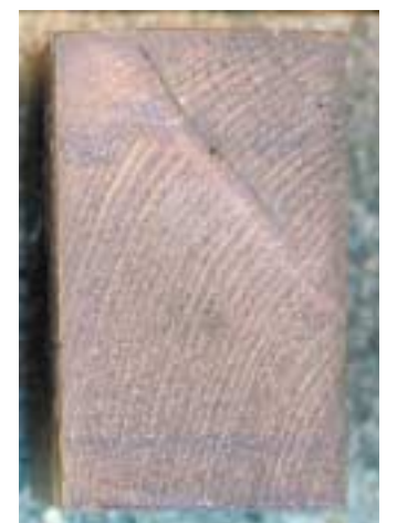
Induline SW-910: Hirnholz wirksam gegen Feuchtigkeit geschützt, die Dimensionen des Holzes bleiben erhalten.
