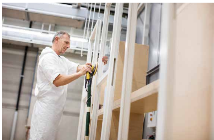
Der Zwischenschliff erfolgt im großdimensionierten Schleifbereich am Powerand-Free-Förderer hängend oder auf Schleiftischen liegend.
