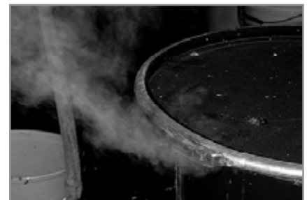
Abb. 6 bis 9: Die Bilder 6 bis 8 zeigen den Herstellprozess des Kalkspatzenmörtels. Feuchter Sand und Branntkalk werde lagenweise in ein Blechfass eingefüllt. Bild 9 dokumentiert die Hitzeentwicklung während des Löschens. Unter dem Rand des nur lose aufliegenden Deckels entweicht Wasserdampf.
