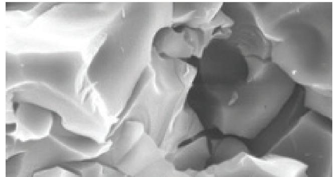
Abb. 1 KSE OH auf Glasfritte; Gelplatten ca. 10  $\mu\text{m}$ .
