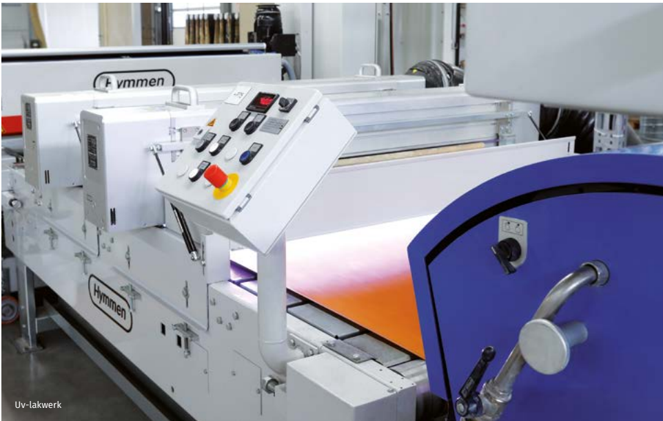
Lakken van trapreden en/of -wangen met volautomatische lakrobot
