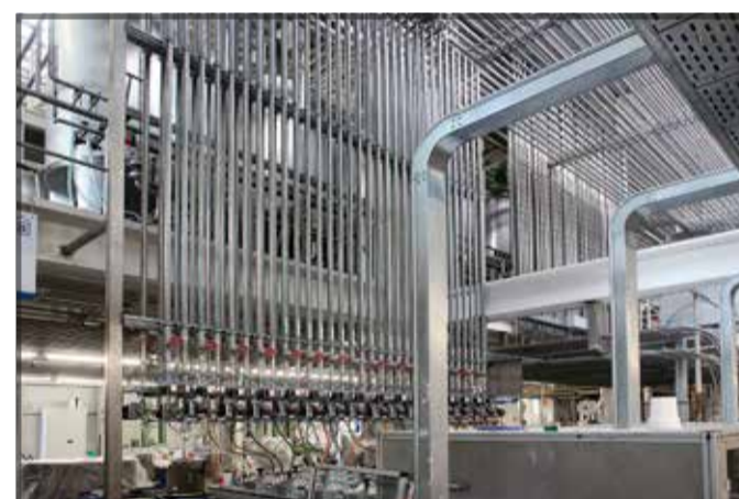
Produkcja tzw. kolorów podstawowych w dziale odcieni specjalnych na produkcji farb dyspersyjnych
