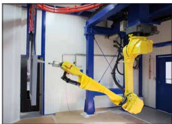
Automatyczny, sześcioksiowy robot lakierniczy z rozpoznawaniem elementów trójwymiarowych
