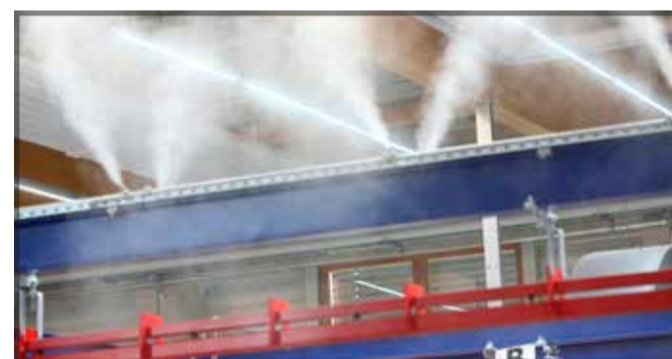
Urządzenia do symulacji różnych stref klimatycznych
