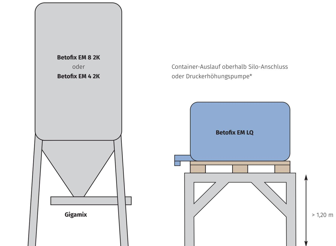
\*Die Entleerung des IBC erfolgt über Schwerkraft, Material wird nicht über Pumpen angesaugt.
