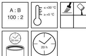
Silicon AFM im Verhältnis 100 : 2 mit Härter AFM mit Spachtel oder Rührwerk homogen bis zur Schlierenfreiheit mischen.
