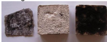
Abb. 4: Eine mit Diesel verschmutzte Gipsoberfläche (rechts),
