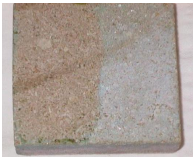
Abb. 10: Ein mit einer \text{CuSO}_4 verschmutzter Euville-Kalkstein. Die linke Seite wurde gereinigt.
