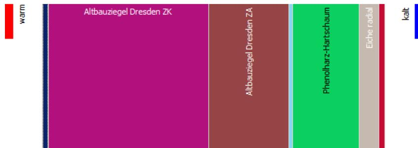
Abbildung 8: Konstruktionsdarstellung
