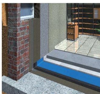
Schematischer Aufbau der Keller-Innenabdichtung im Remmers-System.
